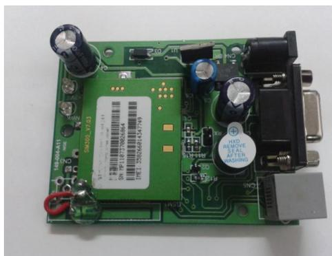
Fig. 7. GSM module
