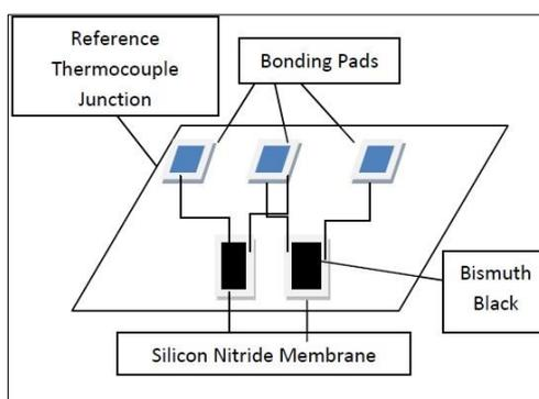
Fig. 4. Thermal detector.
