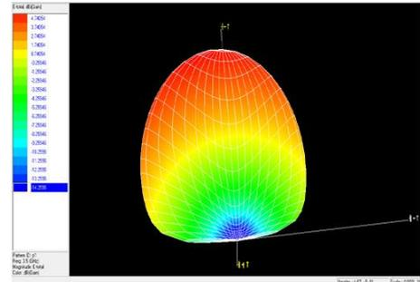
Fig.2 (d) 3-D Gain Polar Pattern of 2x1 Array
