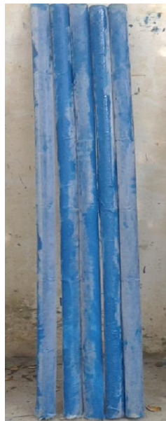
Fig. 2 GFRP wrapped specimens
