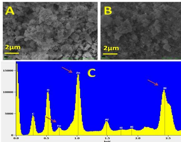
**Fig 1:** SEM image of A) BiFeO<sub>3</sub>, B) ZnO-BiFeO<sub>3</sub> and EDS image of C) ZnO-BiFeO<sub>3</sub>
