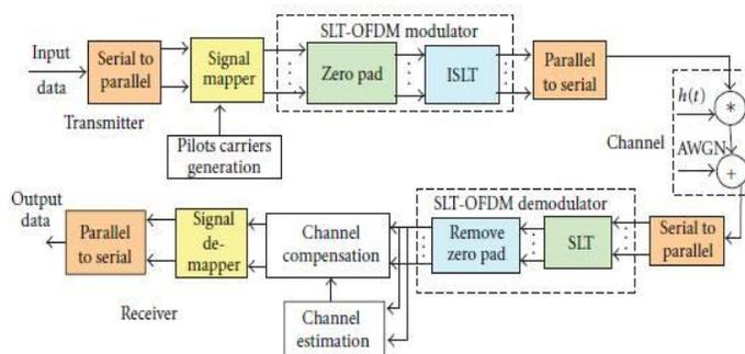
Figure:2 SLT-OFDM Block Diagram
