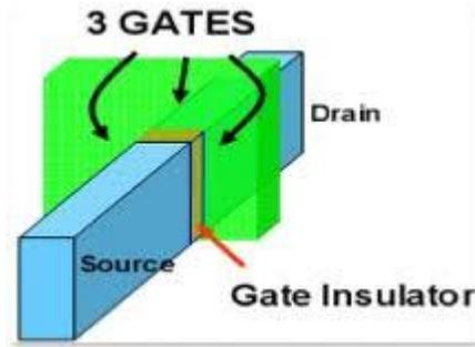
Figure4 : Trigate Structure
