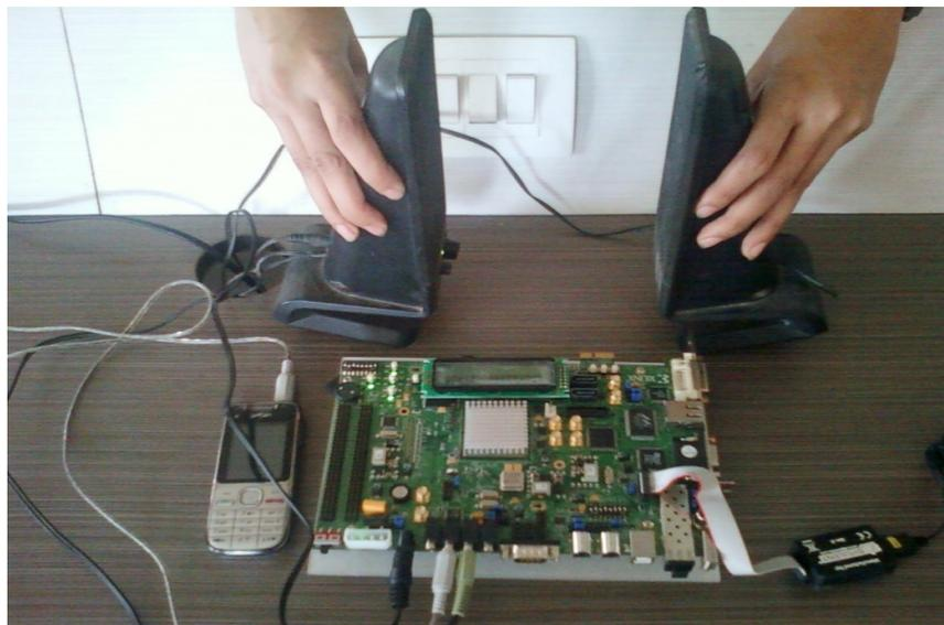
Fig. 8. ANC using FPGA VIRTEX5
