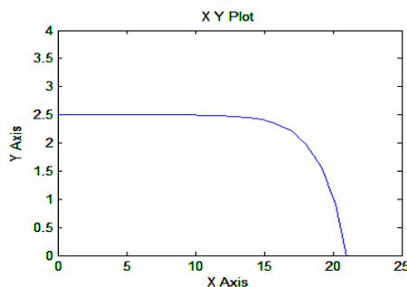
Figure 8. V-I characteristics(irradiation=1000W/m<sup>2</sup>,Temp=25<sup>0</sup>C).
