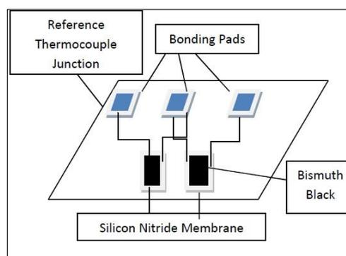
Fig. 4. Thermal detector.
