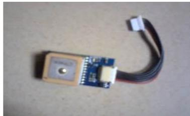
Fig. 1: The GPS Module
