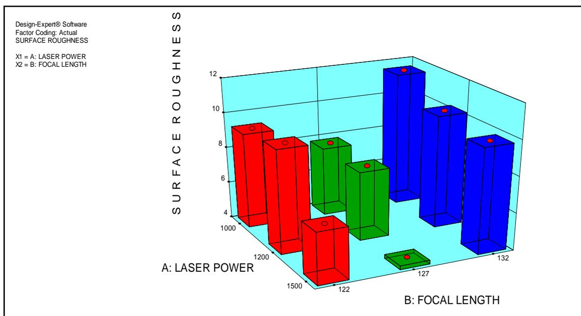
FIGURE 2 LASER POWER, FOCAL LENGTH V/S SURFACE ROUGHNESS OF BRASS
