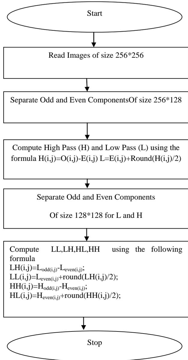
Fig 3.2 : Computation Of Integer Wavelet Transform
