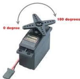
Fig.3. Servo Motor
