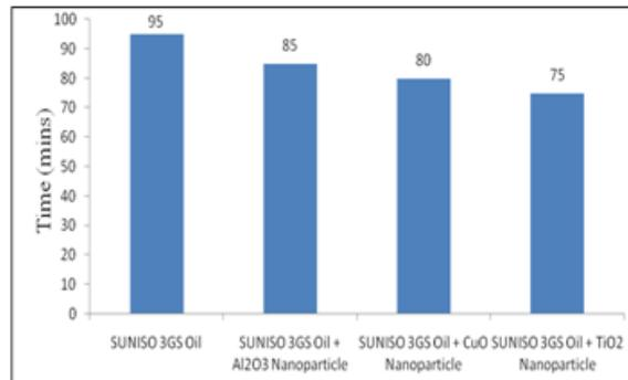
**FIG.2. FREEZING CAPACITY**
