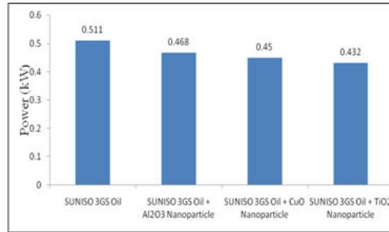
**FIG.3. COMPARISON OF POWER CONSUMPTION**
