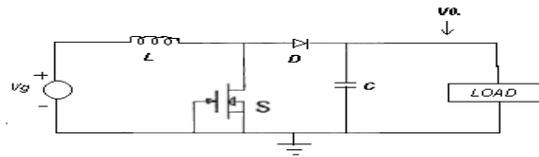
Fig. 1 Boost dc-dc Converter
