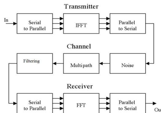
Figure4: OFDM System Architecture
