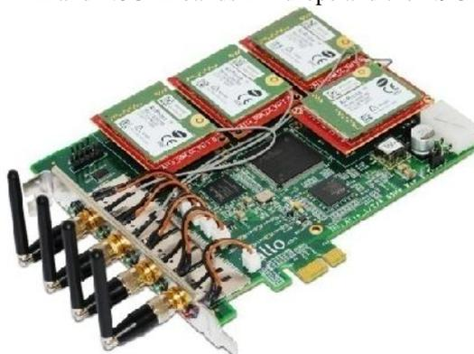
Fig.6 GSM module
