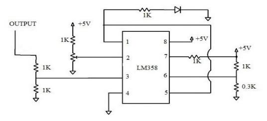
Fig. 4 CO analyser circuit
