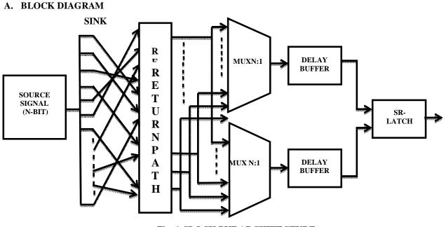
Fig. 1 CLOCK PUF ARCHITECTURE
