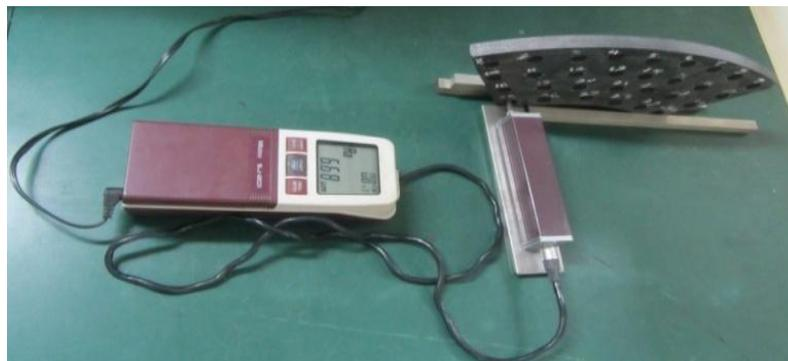
**Fig.2 SURFACE ROUGHNESS TESTER**
