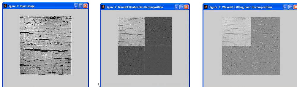
Fig. 4.3 a. Input Image, b. DWT -Daubechies Decomposition , c. Haar Decomposition
