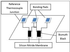
Fig. 4. Thermal detector.
