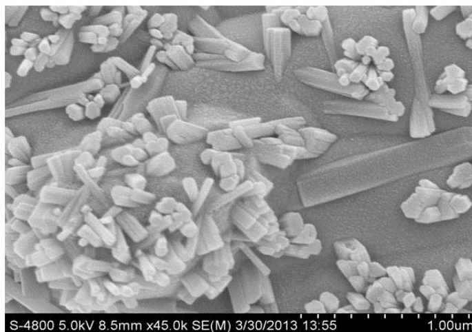
Figure 2: FESEM of \text{Sr}_2\text{CeO}_4: 1.0\% \text{Gd}^{3+}
