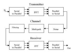
Figure4: OFDM System Architecture
