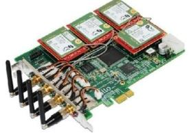
Fig.6 GSM module
